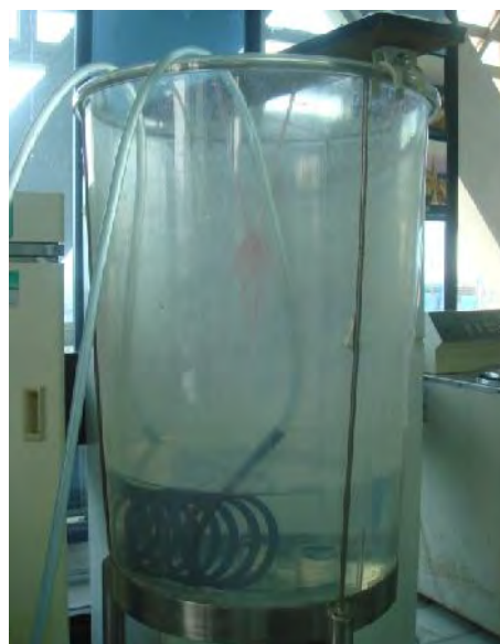
ภาพที่ ค.1 เครื่อง cooling bath ซึ่งต่อกับ cooling coil และการควบคุมอุณหภูมิ โดยให้น้ำไหลผ่าน cooling coil
