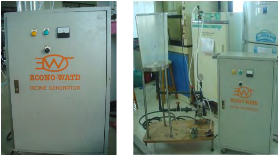
ภาพที่ 3.1 เครื่องผลิตก๊าซโอโซน ยี่ห้อ Econo-Watt รุ่น M15NP (D) กำลังการผลิต 2.1 กรัมต่อชั่วโมง
