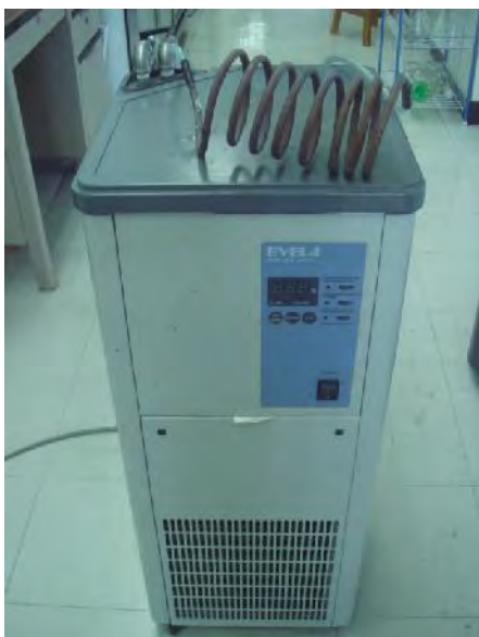
ภาพที่ ค.1 เครื่อง cooling bath ซึ่งต่อกับ cooling coil และการควบคุมอุณหภูมิ โดยให้น้ำไหลผ่าน cooling coil
