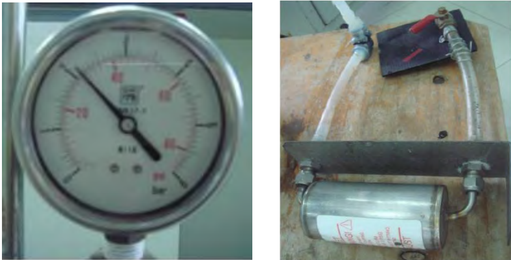
ภาพที่ 3.4 การปรับความดัน 2 บาร์ ของ ozone mixing และ ozonized gas outlet
