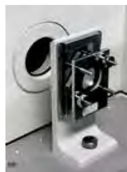
ตำแหน่งยึดอุปกรณ์จับยึด แผ่นเคปียาร์เซลล์
