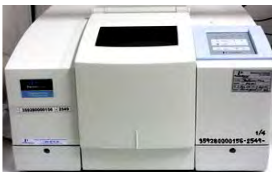
เครื่องฟูเรียร์ทรานสฟอร์มอินฟราเรด (Spectrum One, Perkin Elmer)
