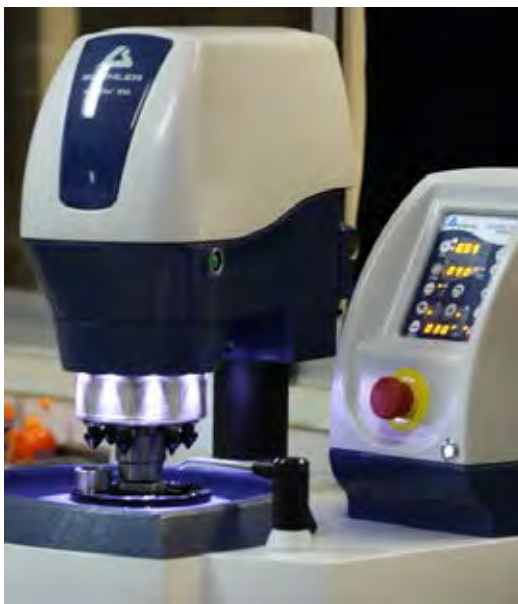
ภาพที่ 8 การขัดผิวเนื้อฟันและผิวคอมพอสิตออนเลย์ด้วยเครื่องขัดผิววัสดุอัตโนมัติ
