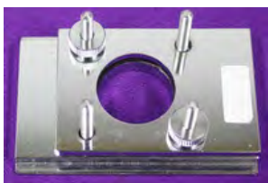
อุปกรณ์สำหรับยึดแผ่นเคปียาร์เซลล์
