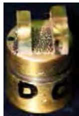
ภาพที่ 18 ชิ้นทดสอบที่ผ่านการเคลือบอนุภาคทอง
