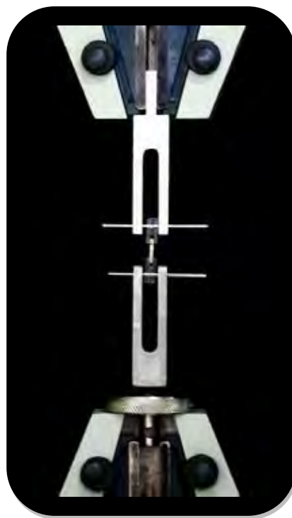
ภาพที่ 16 การประกอบอุปกรณ์ตัวจับยัดเข้ากับเครื่องทดสอบวัสดุเอนกประสงค์
