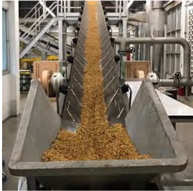
รูป 3.6 ข้าวเปลือกถูกป้อนเข้าสายพานที่ 1
