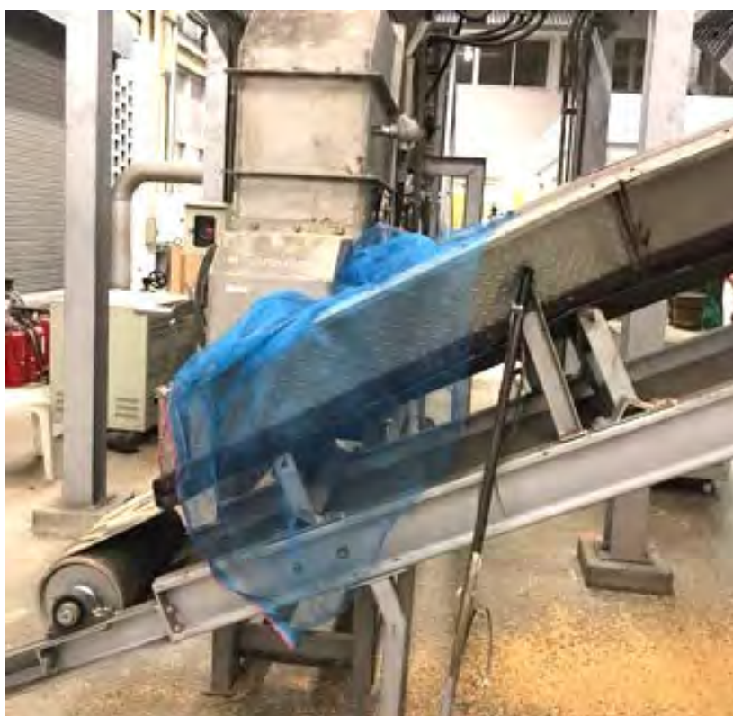
รูป 3.9 ข้าวเปลือกจะออกจากเบตลมร้อนสู่สายพานที่ 2
