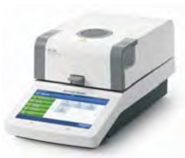
รูป 3.3 เครื่องวัดความชื้น ยี่ห้อ METTLER TOLEDO รุ่น HC103 [32]
