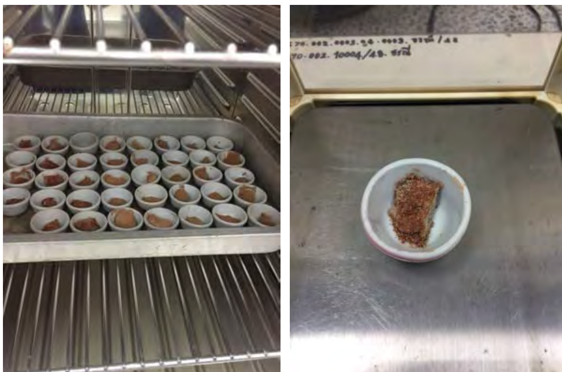
รูปที่ 2-2 ตัวอย่างถูกนำไปอบให้แห้งที่อุณหภูมิ 105 องศาเซลเซียส เป็นเวลา 6 ชั่วโมง (ซ้าย) และนำตัวอย่างมาชั่งเพื่อหามวลแห้งเหลือที่อุณหภูมิ 105 องศาเซลเซียส (ขวา)
