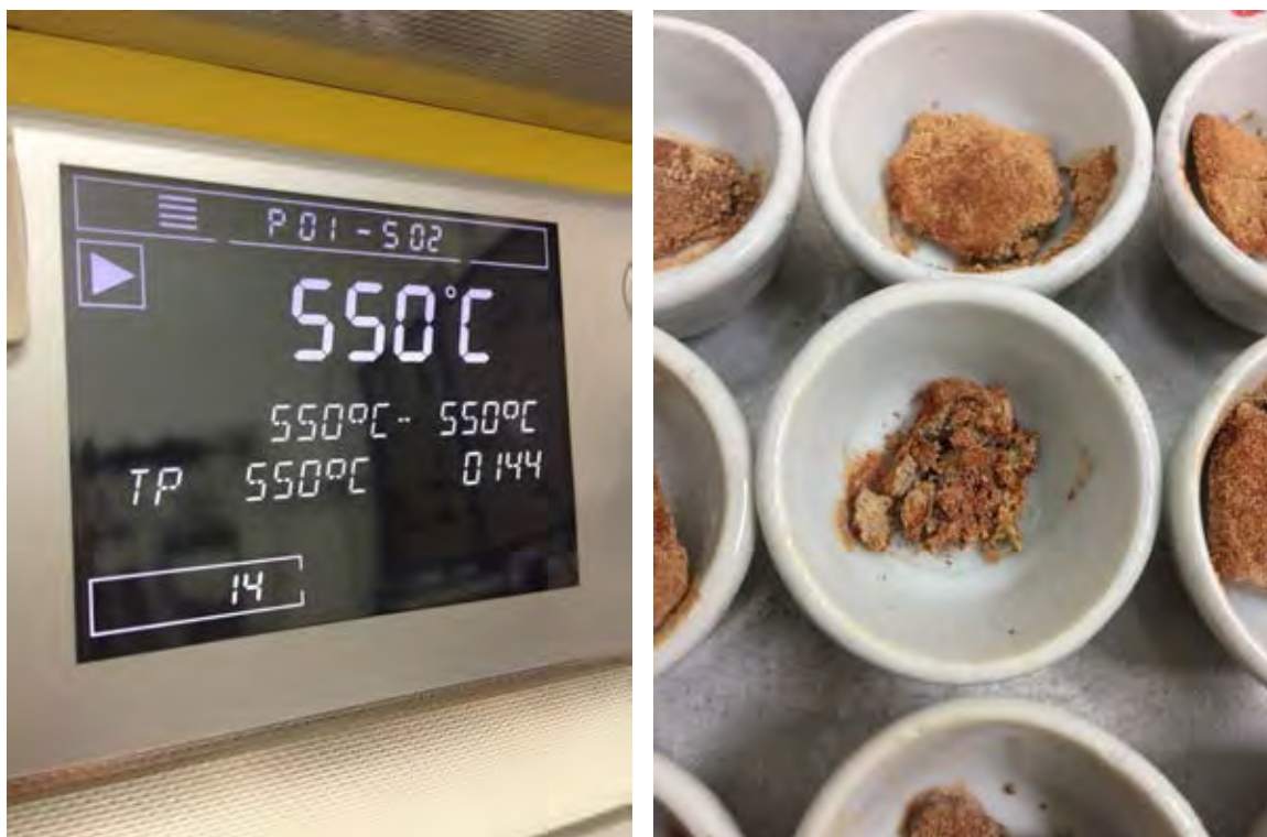
รูปที่ 2-3 การวิเคราะห์ห่มวลที่หายไปจากการเผาที่อุณหภูมิ 550 องศาเซลเซียส เพื่อหามวลที่หายไปหลังจากการเผาเป็นเวลา 4 ชั่วโมง (ซ้าย) และ ตะกอนตัวอย่างหลังเผาที่อุณหภูมิ 550 องศาเซลเซียส (ขวา)
