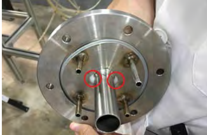
รูปที่ 23 แสดงรอยร้าวที่ตรวจสอบพบของท่อพื้นฟูสภาพตัวดูดซับ
