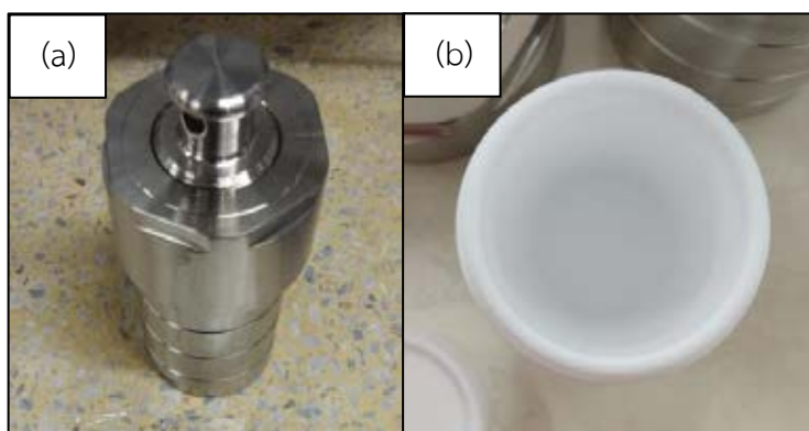
ภาพที่ 3.1 (a) โครงสร้างภายนอกของ mineralization bomb และ (b) หม้อเทฟลอนขึ้นใน
