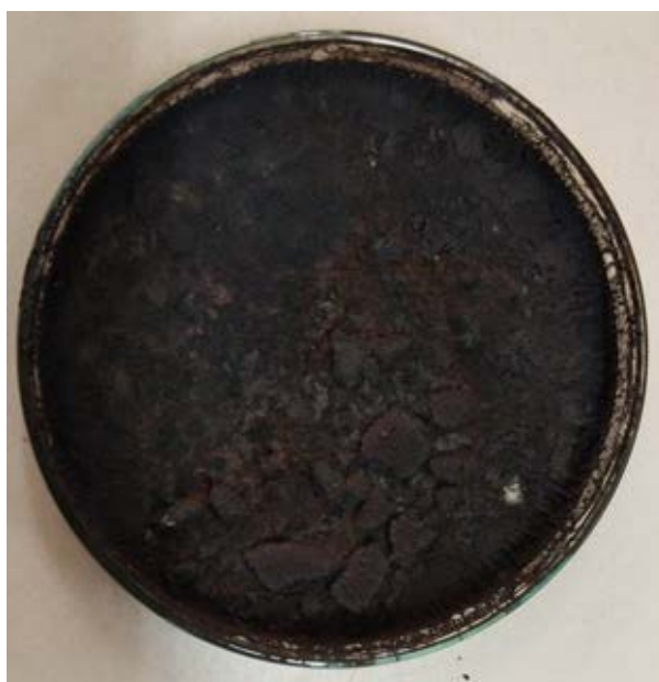
ภาพที่ 4.8 สารผสมสูตร S18B5 หลังกระบวนการไฮโดรเทอร์มัลและอบแห้ง
