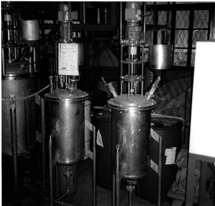
รูปที่ 3.5 เครื่องปฏิกรณ์ถังกวนสำหรับเตรียมน้ำแข็ง
