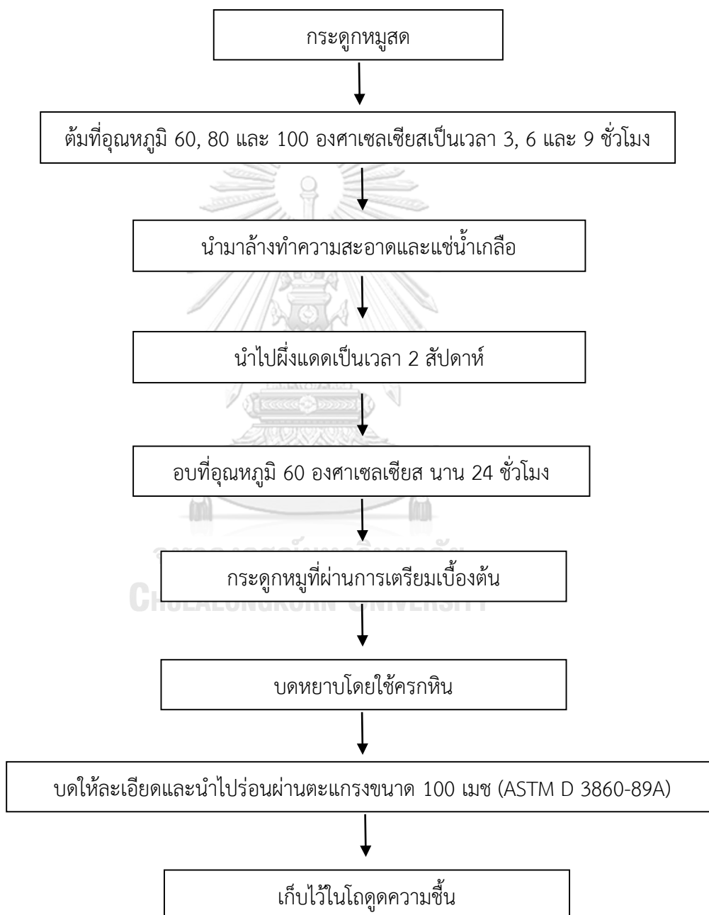
รูปที่ 18 ขั้นตอนการเตรียมกระดูกหมูและผงกระดูกหมู
