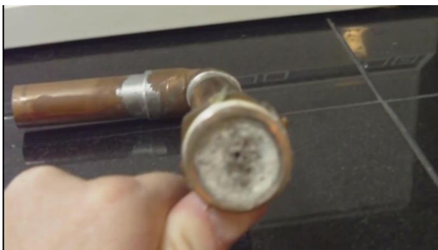
รูปที่ 5.2 ตัวอย่างการเกิดตะกรันในท่อทองแดง
