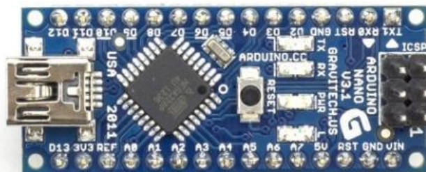
รูปที่ 3.4 บอร์ดไมโครคอนโทรลเลอร์(MCU) Atmega328p
