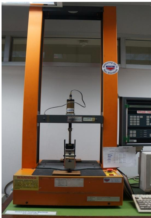
รูปที่ 3.11 เครื่องทดสอบความทนแรงดัดโค้งของชิ้นงาน
