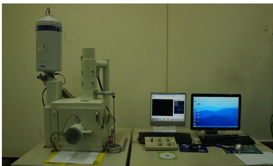
รูปที่ 3.14 กล้องจุลทรรศน์อิเล็กตรอนแบบส่องกราด
