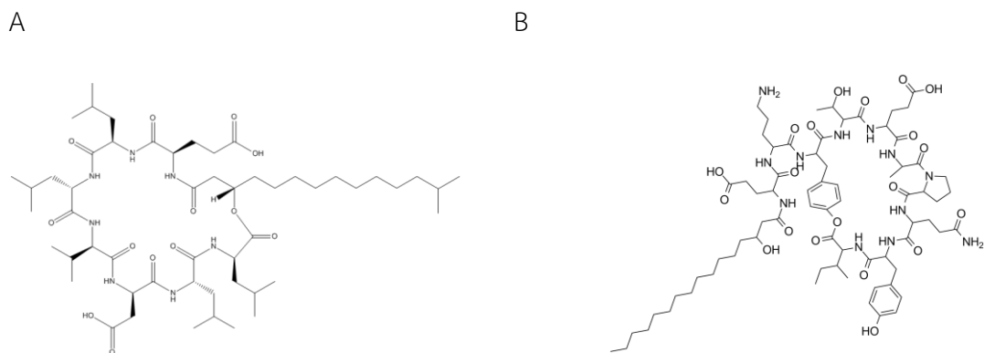
รูปที่ 2.7 โครงสร้างของสารในกลุ่ม lipopeptide Surfactin (A) และ Fengycin (B) (20)
