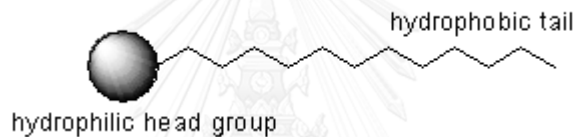
รูปที่ 2.1 โครงสร้างของสารลดแรงตึงผิว (6)
