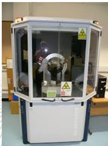
รูปที่ 3.6 เครื่องเอกซเรย์ดิฟแฟรคโทมิเตอร์ ยี่ห้อ Bruker รุ่น D8 Advance.
