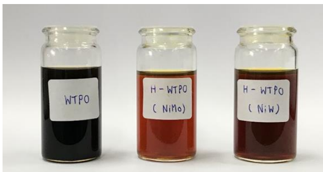
รูปที่ 4.21 WTPO ก่อนและหลังทำปฏิกิริยาด้วยตัวเร่งปฏิกิริยา NiMo และ NiW
