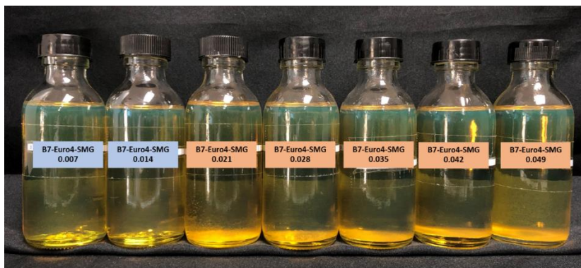
รูปที่ 4-2 B7 ที่ผสมจาก B0 ยูโร4 ที่มีความเข้มข้น SMG ในช่วง 0.007-0.049 wt%
