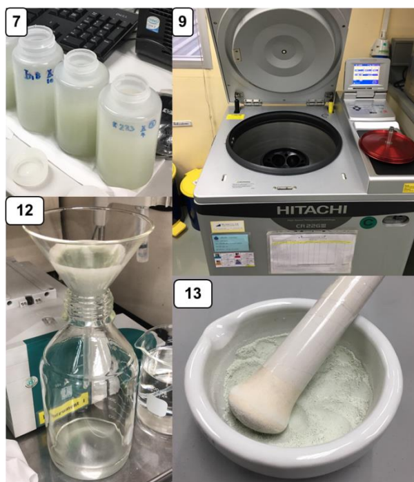
รูปที่ 3-7 ขั้นตอนการตัดแปรตัวดูดซับซีโอไลต์ธรรมชาติ
