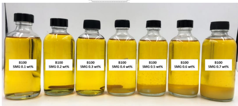
รูปที่ 4-1 ตะกอนที่พบใน B100 ที่มีความเข้มข้น SMG ในช่วง 0.1-0.7 wt% หลังตั้งทิ้งไว้ที่อุณหภูมิห้องมากกว่า 24 ชั่วโมง
