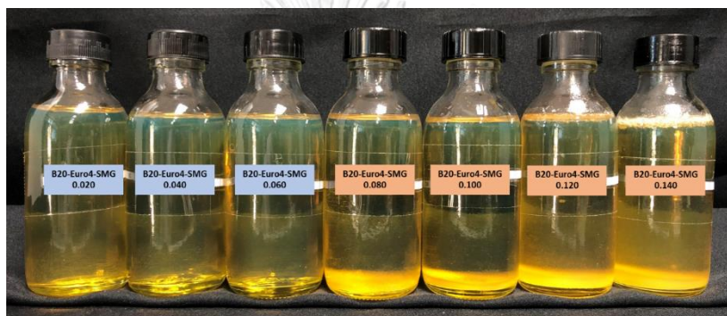
รูปที่ 4-6 B20 ที่ผสมจาก B0 ยูโร4 ที่มีความเข้มข้น SMG ในช่วง 0.020-0.140 wt%
