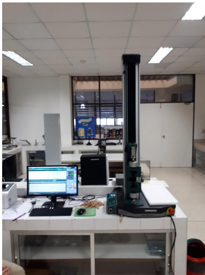
รูปภาพที่ 3.3 เครื่องทดสอบยูนิเวอร์แซล ยี่ห้อ Tinius Olsen
