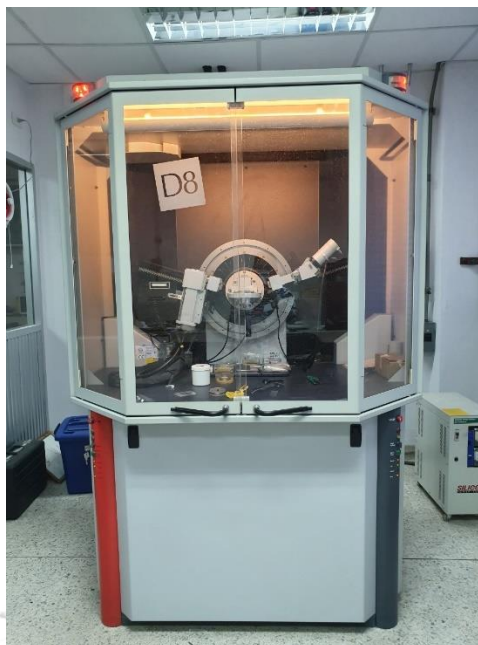
รูปที่ 3.3 เครื่องวิเคราะห์การเลี้ยวเบนรังสีเอกซ์ รุ่น D8 Advance ยี่ห้อ Bruker
