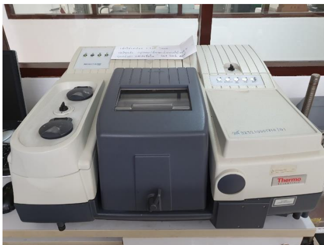
รูปที่ 3.2 เครื่องฟูรีเยร์ทรานส์ฟอร์มอินฟราเรดสเปกโตรมิเตอร์ รุ่น Nicolet 6700 ยี่ห้อ Thermo
