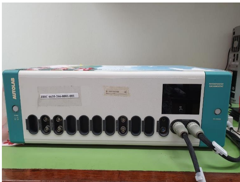
รูปที่ 3.5 เครื่องทดสอบสมบัติไฟฟ้าเคมี Autolab Potentiostat/Galvanostat รุ่น PGSTAT-30 ยี่ห้อ Metrohm Autolab
