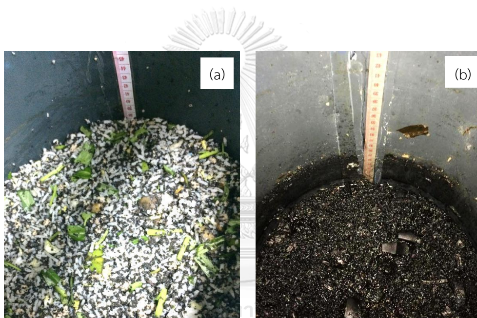
รูปที่ 4-40 การยุบตัวของขยะสังเคราะห์ในถังปฏิกรณ์หลุมฝังกลบชุดควบคุม (a) เริ่มต้นการทดลอง และ (b) สิ้นสุดการทดลอง
