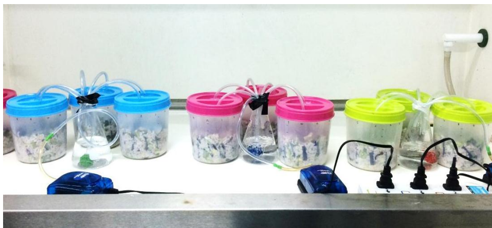
รูปที่ 3-5 ชุดทดสอบการย่อยสลายในสภาวะมีออกซิเจน
