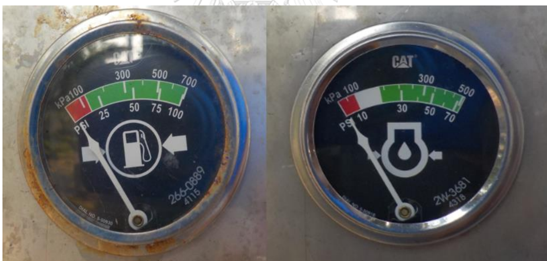
รูปที่ 5.8 เกจสำหรับตรวจสอบความดันน้ำมันเครื่องและน้ำมันเชื้อเพลิง
