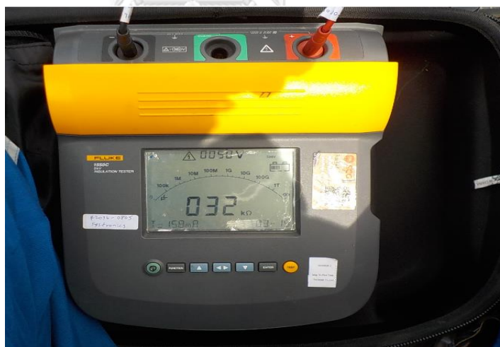
รูปที่ 5.3 แสดงการวัดความต้านทานของขดลวดมอเตอร์
