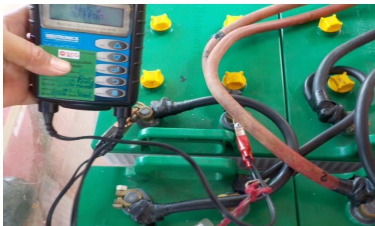
รูปที่ 5.5 การตรวจวัดความต่างศักย์ของแบตเตอรี่
