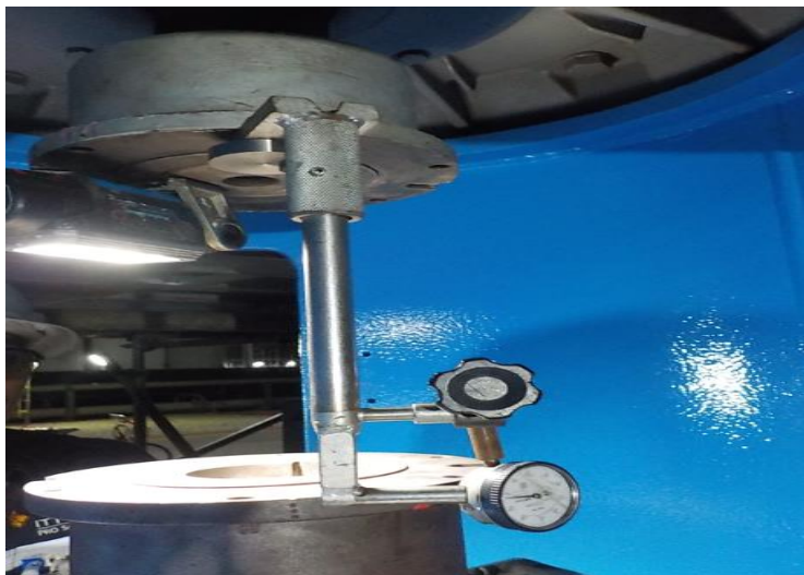
รูปที่ 5.4 ตรวจสอบการร่วมศูนย์ของมอเตอร์ไฟฟ้า
