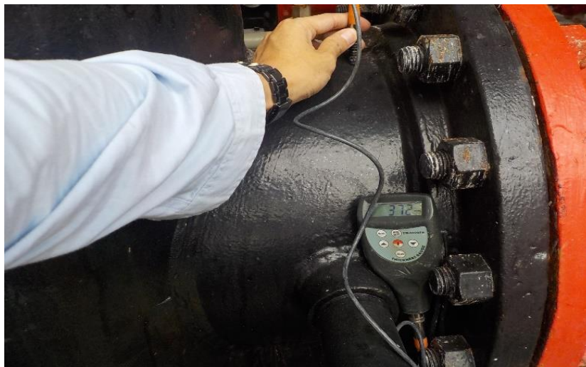
รูปที่ 5.14 การตรวจวัดความหนาของผนังเครื่องสูบ
