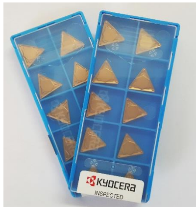
รูปที่ 3.3 เม็ดมีดที่ใช้ในการทดลอง มุมคายเศษโลหะ -6 องศา
