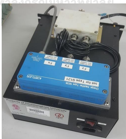
รูปที่ 3.8 เครื่องขยายสัญญาณ (Charge Amplifier)
