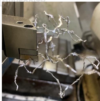
รูปที่ 4.69 การพอกติดของเศษอะลูมิเนียมกับมีดตัดที่คมตัดและเศษอะลูมิเนียม
