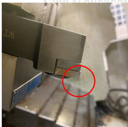
รูปที่ 4.69 การพอกติดของเศษอะลูมิเนียมกับมีดตัดที่คมตัดและเศษอะลูมิเนียม
