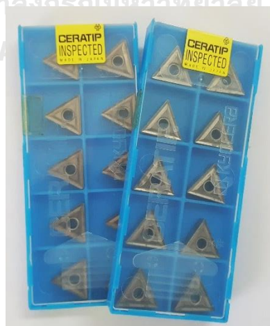
รูปที่ 3.4 เม็ดมีดที่ใช้ในการทดลอง มุมคายเศษโลหะ 11 องศา
