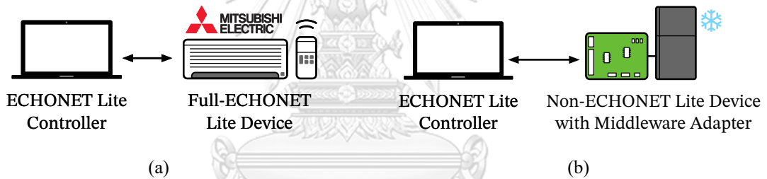
รูปที่ 3.7: การเชื่อมต่ออุปกรณ์ไฟฟ้าเข้ากับโดเมนในโพรโทคอล ECHONET Lite (a) เครื่องปรับอากาศ Full ECHONET Lite (b) ตู้เย็น non-ECHONET Lite เชื่อมต่อเข้ากับ ECHONET Lite มิดเดิลแวร์อะแดปเตอร์
