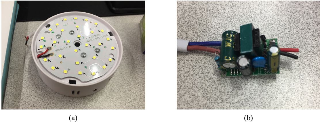
รูปที่ 6.16: ส่วนประกอบภายในหลอดไฟที่เลือกใช้ (a) แผ่นวงจรของหลอดไฟซึ่งทำมาจากแผ่นวงจรพิมพ์และไดโอดเปล่งแสง (b) วงจรแหล่งจ่ายไฟสำหรับขับหลอดไฟ
