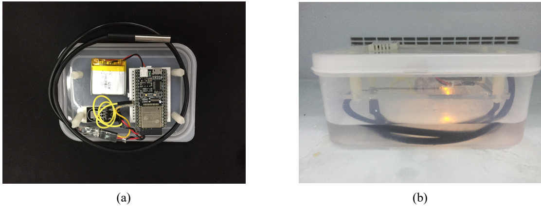
รูปที่ 6.10: (a) ส่วนประกอบตัวรับรู้อุณหภูมิไร้สาย (b) การใช้งานตัวรับรู้อุณหภูมิไร้สาย
