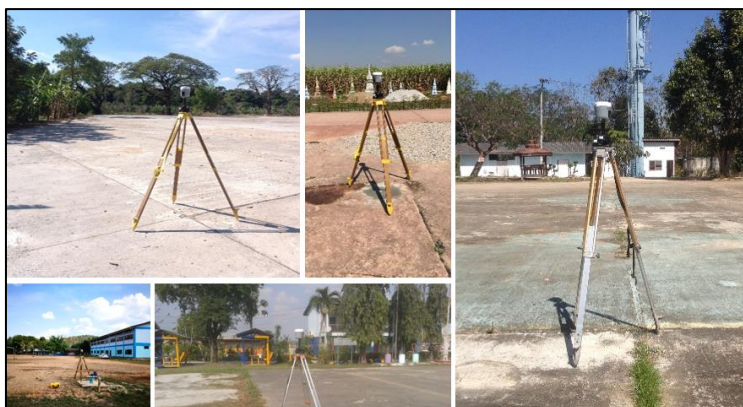
ภาพที่ 2 ตัวอย่างสถานที่รับสัญญาณ GNSS สำหรับการเก็บข้อมูลเพื่อมาวิเคราะห์
