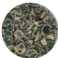
ภาพที่ 4-7 ตัวอย่างซากแผงวงจรอิเล็กทรอนิกส์หลังผ่านการบดลดขนาด
