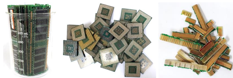
ภาพที่ ก.1 ซากแผงวงจรอิเล็กทรอนิกส์ชนิดหน่วยความจำ ซีพียูและส่วนประกอบของการ์ดแสดงผลที่ใช้ในการทดลอง
