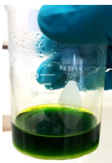
ภาพที่ ก.5 การชะละลายซากแมงวงจรรีเล็กทรอนิกส์ด้วยกรดกัดทอง
