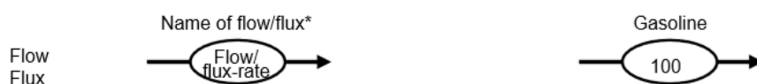
ภาพที่ 2-4 สัญลักษณ์และตัวอย่างของอัตราการไหล (Flow) และฟลักซ์ (Flux)
