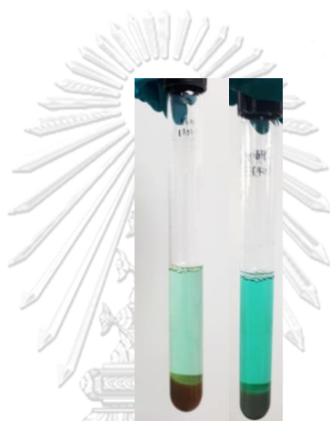
ภาพที่ ก.6 การตกตะกอนด้วยโซเดียมเมตาไบซัลไฟด์
