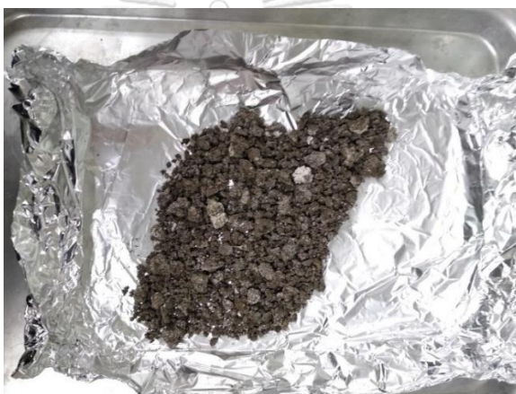
ภาพที่ ข- 2 ตะกอนจากระบบบำบัดน้ำเสียรวมแบบชีวภาพ จุฬาลงกรณ์มหาวิทยาลัย
