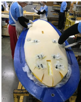
รูปที่ 1.5 แสดงกระบวนการบีบอัดโฟม [1]
