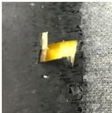
รูปที่ 4.35 แสดงลักษณะทางกายภาพของจุดที่ไม่มีการยึดติดของวินเซิร์ฟ 4 [1]
