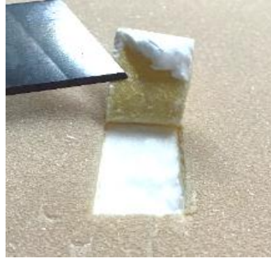
รูปที่ 4.25 แสดงลักษณะทางกายภาพของจุดที่มีการยึดติดของวินเซิร์ฟ 3 [1]
