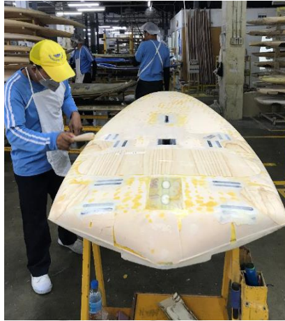
รูปที่ 3.6 แสดงกระบวนการเคาะเรือ [1]
