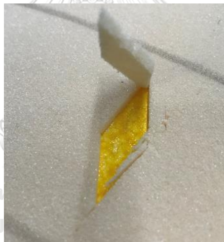
รูปที่ 4.29 แสดงลักษณะทางกายภาพจุดที่ไม่มีการยึดติดของวินเซิร์ฟ 3 [1]
