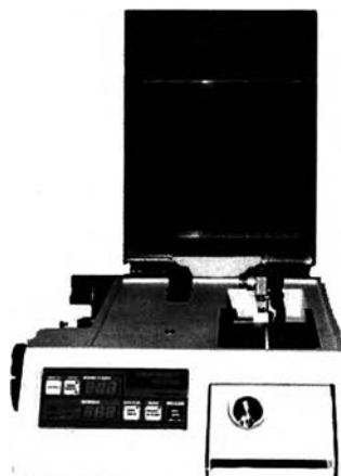
ภาพที่ 15 เครื่องตัดฟันใบเลื่อยเพชรชนิดความเร็วต่ำ
