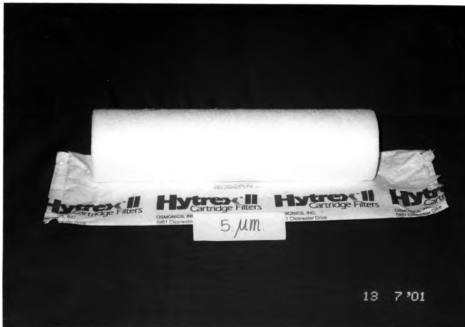
รูปที่ 3.6 Cartridge Filter ขนาดรูพรุน 5 \mu\text{m}
