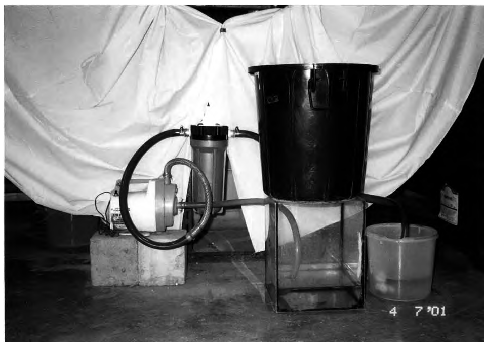
รูปที่ 3.5 ชุดเครื่องมือที่ใช้บำบัดน้ำดิบขั้นต้น
