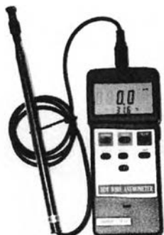
รูปที่ 4.14 อุปกรณ์วัดความเร็วลม
