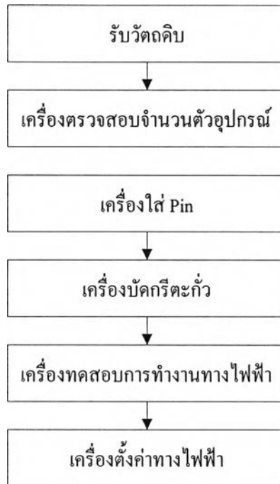
รูปที่ 3.12 แสดงแผนผังการวางเครื่องจักรในพื้นที่ CTV-CA
