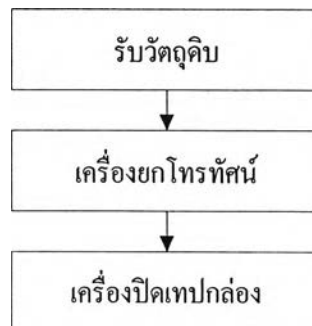
รูปที่ 3.15 แสดงแผนผังการวางเครื่องจักรในพื้นที่ Packing
