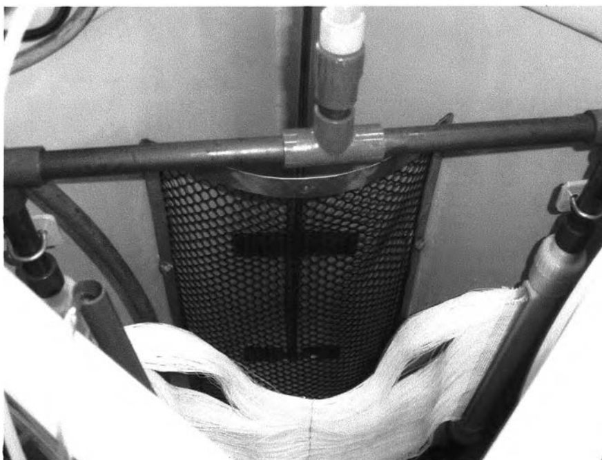
รูปที่ 3.3 ส่วนประกอบของชุดเมมเบรนที่ใช้ในงานวิจัยนี้
