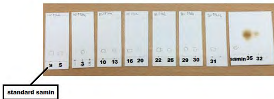
รูปที่ 3.5 แผนภาพ TLC ของซามิน หลังทำการแยกด้วยเทคนิคคอลัมน์โครมาโทกราฟี
