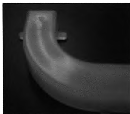
รูป 3.14 แสดงการยุบตัวของชิ้นงาน (Sink Mark)
