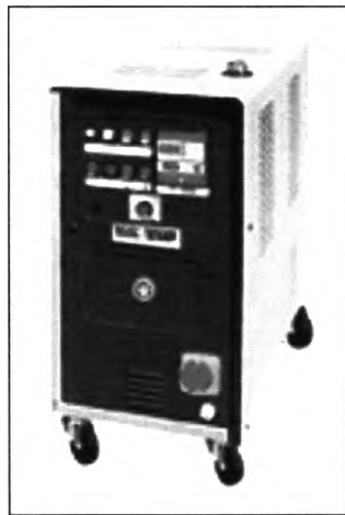
รูป 4.4 แสดงชุดควบคุมอุณหภูมิของแม่พิมพ์ที่ใช้ในการทดลอง
