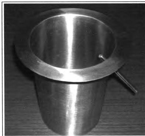
รูป 4.5 เครื่องมือวัดปริมาตรแก๊สภายในชิ้นงาน
