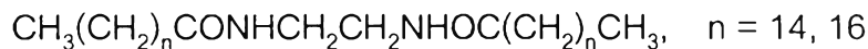
รูปที่ 2.6 สูตรโมเลกุลของเอทิลีนบิสสเตียราไมด์
