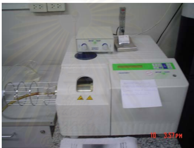
รูปที่ 3.8 เทอร์โมกราวิเมตริกแอนาไลเซอร์ของ Mettler Toledo รุ่น TGA/SDTA 851
