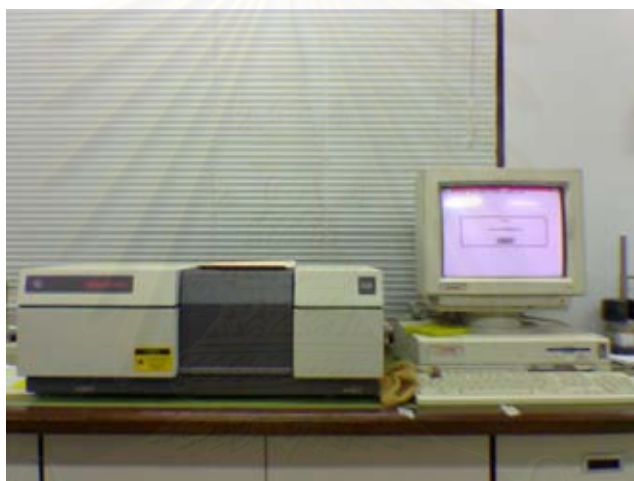
รูปที่ 3.5 ฟูเรียร์ทรานสฟอร์มอินฟราเรดสเปกโทรโฟโตมิเตอร์ของ Nicolet รุ่น Impact 400D
