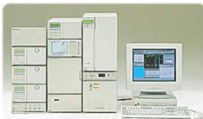
รูปที่ 3.6 เจลเพอมีเอชันโครมาโทกราฟของ Waters รุ่น Waters 1551
