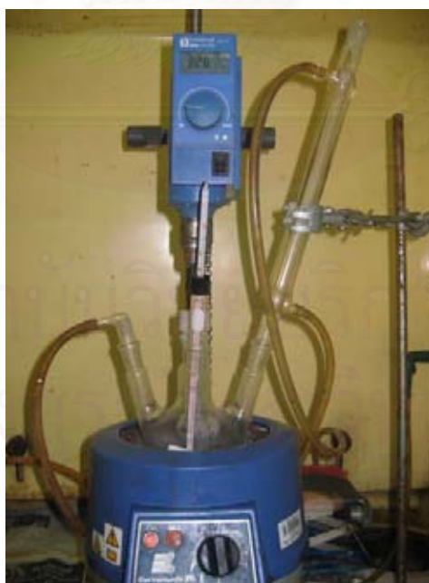
รูปที่ 3.2 ชุดอุปกรณ์การสังเคราะห์แป้งข้าวเหนียวกราฟต์พอลิเมทิลเมทาคริเลต
