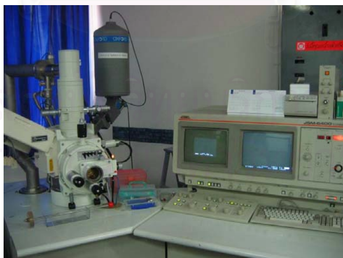
รูปที่ 3.7 กล้องจุลทรรศน์อิเล็กตรอนแบบส่องกราดของ JEOL รุ่น JSM-6400
