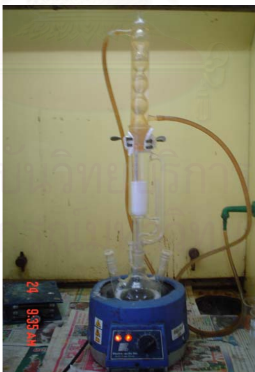
รูปที่ 3.3 ชุดอุปกรณ์การสกัดซอกซ์เลต
