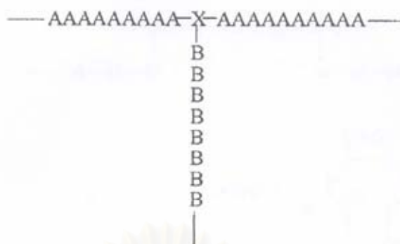
รูปที่ 2.4 โครงสร้างโมเลกุลของกราฟต์โคพอลิเมอร์ [9]
