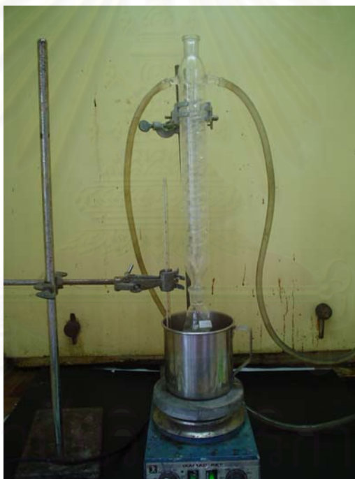
รูปที่ 3.4 ชุดอุปกรณ์การไฮโดรลิซิสกราฟต์โคพอลิเมอร์ด้วยกรด
