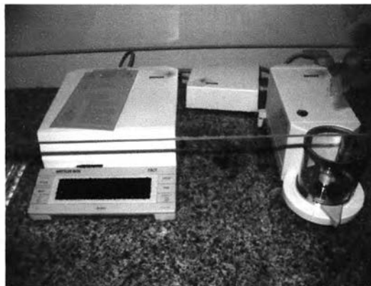
รูปที่ 3.9 เครื่องชั่งที่มีทศนิยม 6 ตำแหน่ง METLER UMT 5
