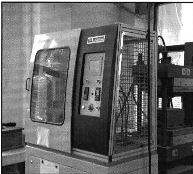
รูปที่ 3.6 เครื่องอัดแบบของ Lab Tech Engineering
