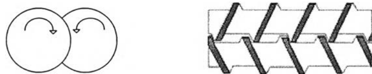
รูปที่ 2.20 สกรูคู่แบบหมุนในทิศทางตรงข้ามกันหรือสวนทางกัน (counter rotating screws) [19]
