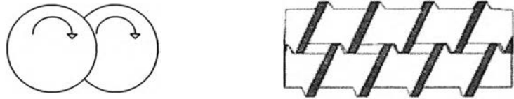
รูปที่ 2.19 สกรูคู่แบบหมุนในทิศทางเดียวกัน (co-rotating screws) [19]
