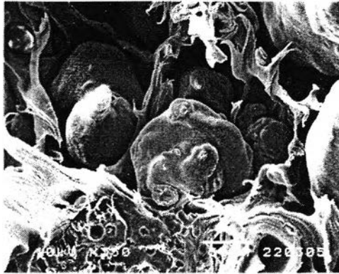
รูปที่ 4.12 สัมฐานวิทยาของซันทศอบที่มี อัตราส่วน LDPE/PE wax/starch : 80/20/100
