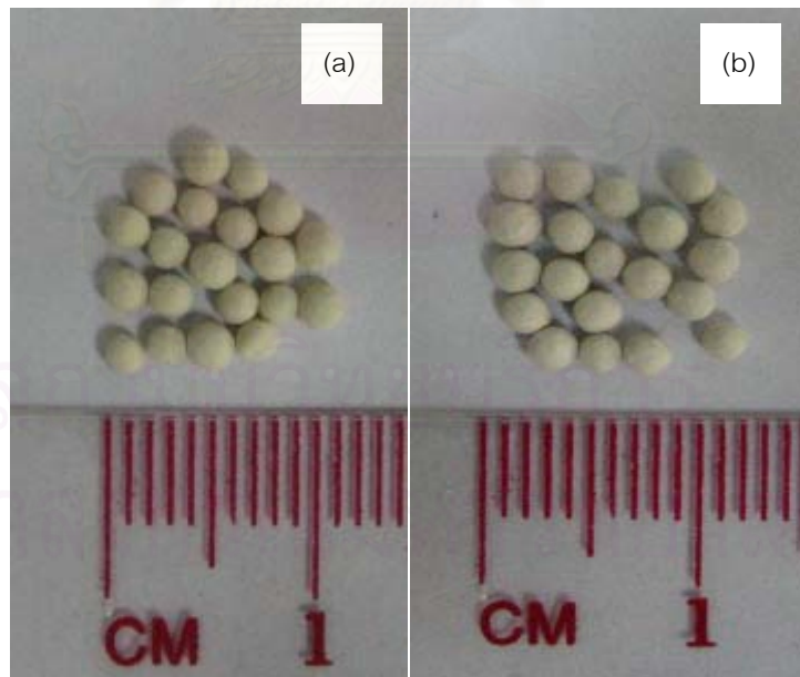
รูปที่ 4.1 ลักษณะของโมเลกุลาร์ซีฟ PCL-100 (a) โมเลกุลาร์ซีฟยังไม่ผ่านการใช้งาน (b) โมเลกุลาร์ซีฟผ่านการใช้งานแล้ว
