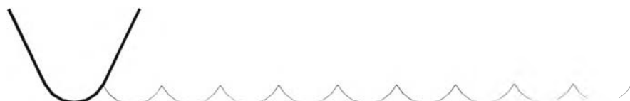
รูปที่ 1.5 แสดงผิวของชิ้นงานที่ได้จากมีดตัดป้าน (Round tool)
