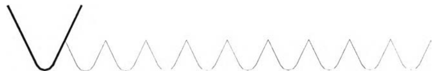
รูปที่ 1.4 แสดงผิวของชิ้นงานที่ได้จากมีดตัดคม (Sharp tool)
