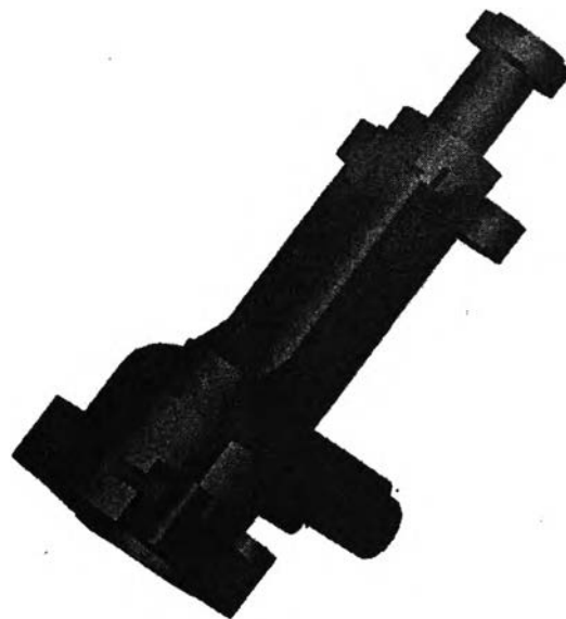
รูปที่ 3.10 รูปแสดงภาพชิ้นงาน 3มิติ แบบรูปร่างของแข็ง (solid)
