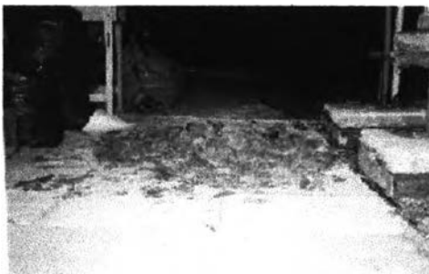
รูปที่ 6.7 รูปแบบการกระจายของใบไม้เมื่อใช้ใบป้อนแบบใบซี่ตัดตรง
