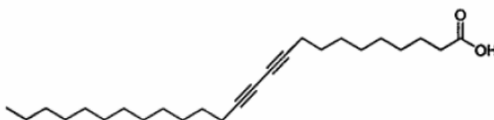
รูปที่ 2.7 โครงสร้างของ 10,12-เพนตะโคเซ ไดอายนโนอิกแอซิด (PCDA)
