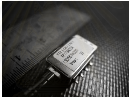
รูปที่ 3.9 ตัวรับแสงที่ใช้ในการทดลอง(ของบริษัท Triquint Semiconductor model P173A) เป็นตัวรับแสงประเภท APD และมี TIA รวมอยู่ในโมดูลด้วย
