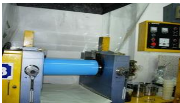
ภาพที่ 2.16 เครื่องผสมแบบ 2 ลูกกลิ้ง (two-roll mill)
