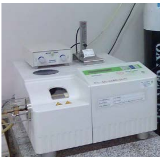
ภาพที่ 3.9 เครื่องวิเคราะห์น้ำหนักภายใต้ความร้อน (ทีจีเอ) (Mettler Toledo, TGA/SDTA 851°)
