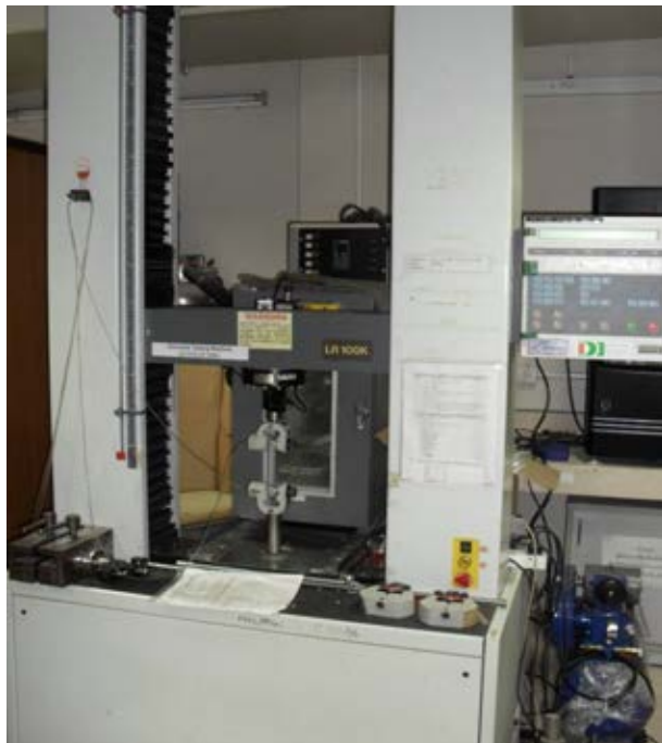
ภาพที่ 3.6 เครื่องทดสอบยูนิเวอร์แซล (LLOYD รุ่น LR 100K)
