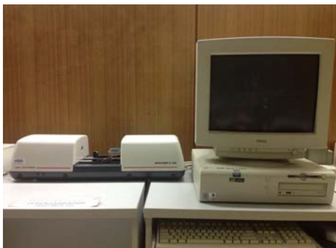
รูปที่ 3.5 เครื่องอัลตราไวโอเล็ตสเปกโทรโฟโตมิเตอร์ รุ่น specord s 100
