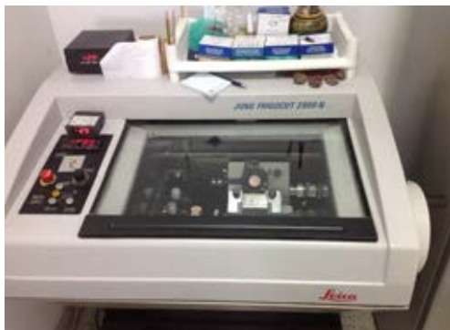
รูปที่ 3.8 เครื่อง Cryostat Microtome ยี่ห้อ Leica รุ่น Jung Frigocut 2800 N
