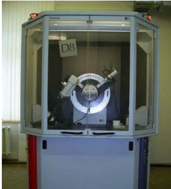
รูปที่ 3.6 เครื่องเอกซเรย์ดิฟแฟรคโตมิเตอร์ รุ่น D8 Advanced
