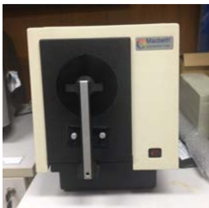
รูปที่ 3.11 เครื่องวัดสี Reflectance Spectrophotometer รุ่น Macbeth Color Eye 7000
