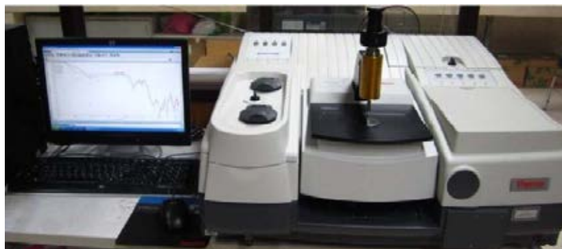
รูปที่ 3.4 เครื่องฟูเรียร์ทรานสฟอร์มอินฟราเรดสเปกโทรโฟโตมิเตอร์ รุ่น Nicolet 6700
