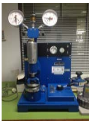
รูปที่ 3.13 เครื่องทดสอบความต้านแรงดันทะเล รุ่น CY-6103A1
