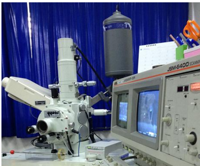
รูปที่ 3.9 กล้องจุลทรรศน์อิเล็กตรอนแบบส่องกราด (SEM) รุ่น JSM-6400
