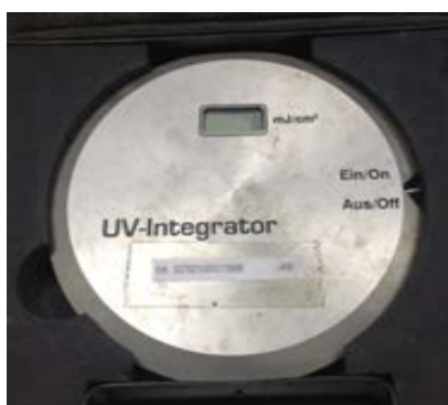
รูปที่ 3.3 งานวัดค่าพลังงานความเข้มแสงยูวี
