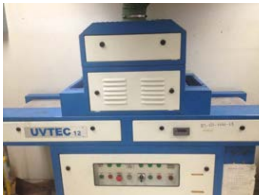
รูปที่ 3.2 เครื่องปั๊มสารเคลือบผิวแสงยูวี รุ่น UVTEC12
