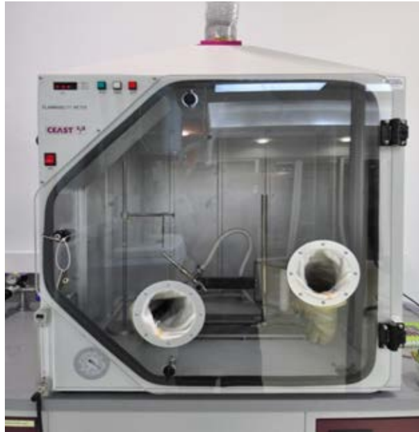
ภาพที่ 3.21 ตู้ทดสอบการต้านการติดไฟ
