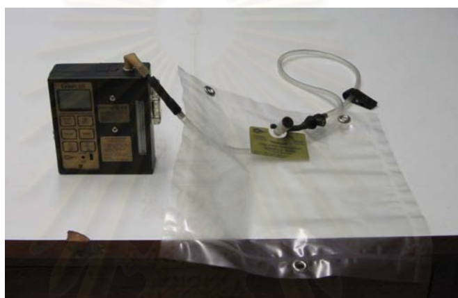
ภาพที่ 3.9 การต่อ personal pump เข้ากับถุงเก็บอากาศ (air bag)
