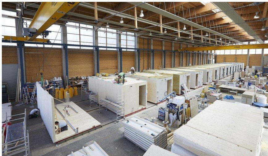
รูปที่ 10 กระบวนการผลิตอาคารโครงสร้างสำเร็จรูประบบกล่อง ที่มา https://www.modular.org/HtmlPage.aspx?name=why_modular
