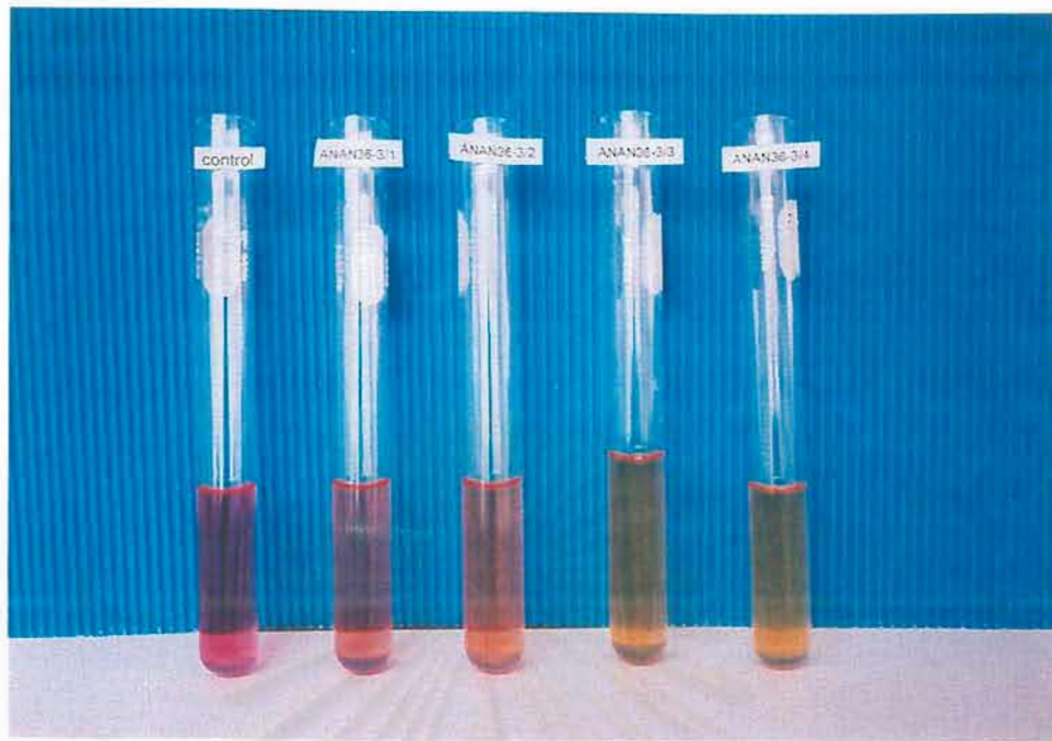
รูปที่ 4.14 แสดงการกำจัดสี Reactive Red 2 ในสภาวะแอนแอโรบิกของเชื้อ รหัส ANAN 36-3 ที่เวลา 12,84,120 และ 168 ชั่วโมง
